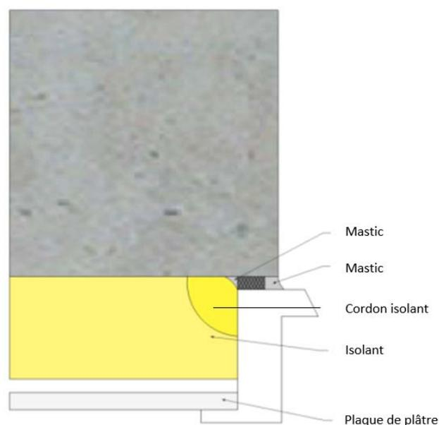
**Figure 6 : Menuiserie calfeutrée en tunnel, fixée en tableau**
