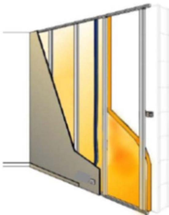
*Figure 10 : Contre-cloison constituée de fourrures avec appuis intermédiaires clipsés*
